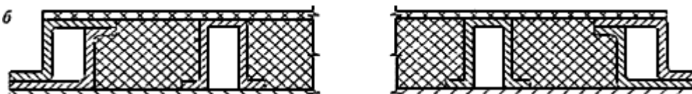
Полотно с наружным стальным листом и внутренним листом из ДВП, с профилями сложного сечения и наполнением из древесного или минерального утеплителя
