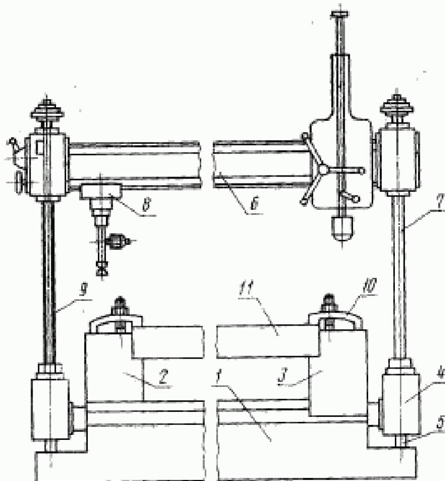
1—основание машины; 2—неподвижная опора; 3—подвижная опора; 4—каретка; 5—направляющая каретки; 6—траверса; 7—колонка для перемещения траверсы; 8—датчик сил; 9—индикатор перемещений; 10—архивы; 11—испытуемое изделие.
