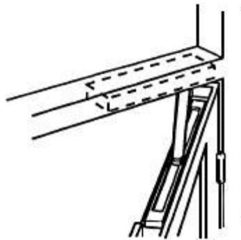
г) Врезной (скрытый) доводчик для распашной двери (тип ДВ)
