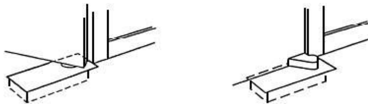
д) Скрытый доводчик нижнего расположения, монтируемый в пол (тип ДП)
